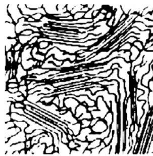
Die Molekülketten liegen teilweise parallel, dicht nebeneinander (kristalline Struktur), zeigen aber auch amorphe Bereiche. Erst oberhalb des Kristallitschmelzbereiches beginnt der thermoplastische Zustand.
