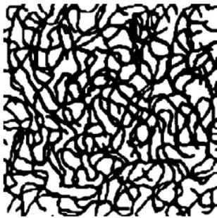
Die Molekülketten sind ineinander verfilzt. Zwischen den Polymeren bestehen zwischenmolekulare Bindungskräfte. Sie besitzen meist einen etwas größeren Umformbereich als teilkristalline Thermoplaste.
