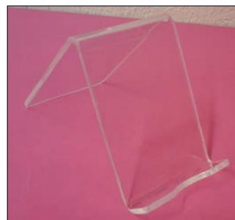
Das Sägen und Feilen bzw. Schleifen (am besten mit Nass-Schleifpapier) von Acrylglas vollzieht sich wie bei den Materialien Holz oder Metall. Beim Biegen ist darauf zu achten, dass das Material nicht zu heiß wird, da sich sonst kleine, unschöne Bläschen bilden oder das Material schmilzt.
